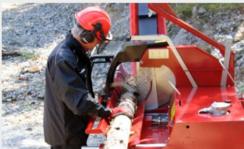
Подводящий стол движется горизонтально и снабжен шарикоподшипниками. Благодаря этому на JAРА 700 работает легко.
