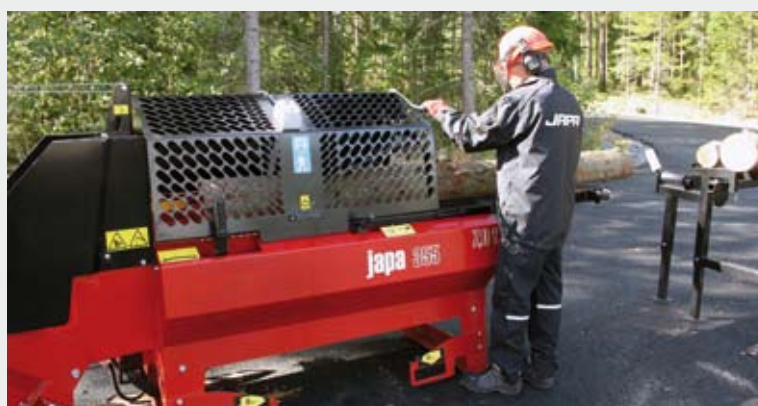
7 тонный раскалывающий цилиндр легко и без труда раскалывает большие поленья.
